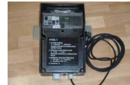
Obr. 10. Ovládací skříňka (měnič napětí) odpuzovače VYZA
